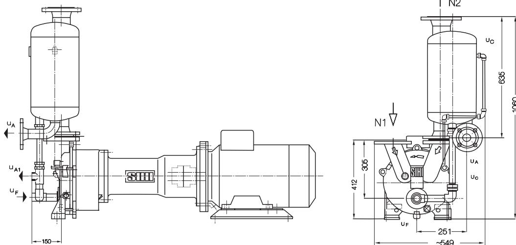
N 1=gas inlet DN 65 吸气口 DN 65
