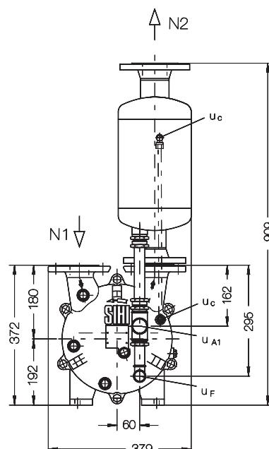
N 1=gas inlet DN 50 吸气口 DN 50
