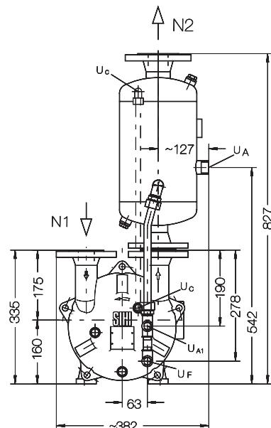
N 1=gas inlet DN 40 吸气口 DN 40
